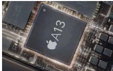
苹果A13制造工艺：7nm (每个元件宽度7nm) 拥有85亿个晶体管
